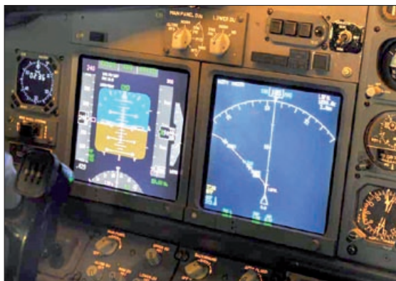
Bild 8. EGNOS-Darstellung der Empfängerinformationen auf herkömmlichen Luftfahrzeug-Displays. (Foto: BAZL)
