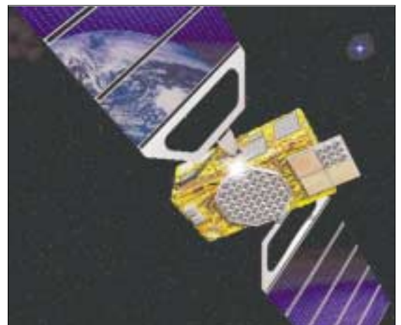
I Bild 12. Ein Galileo-Satellit hat eine Masse von rund 680 kg.
