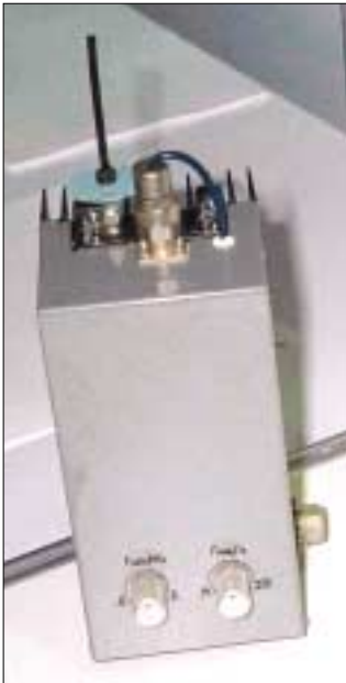
Bild 4. Ein GPS-Störsender mit einer Ausgangsleistung von 4 W kann im Umkreis von 200 km stören [3].
