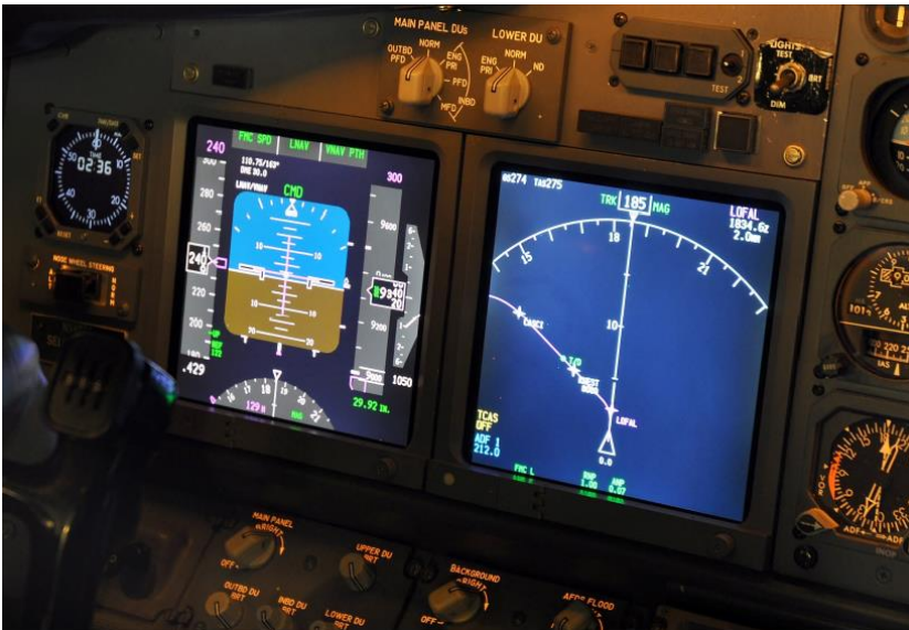
Bild 11: EGNOS-Darstellung der Empfängerinformationen auf herkömmlichen Displays (Foto BAZL)
