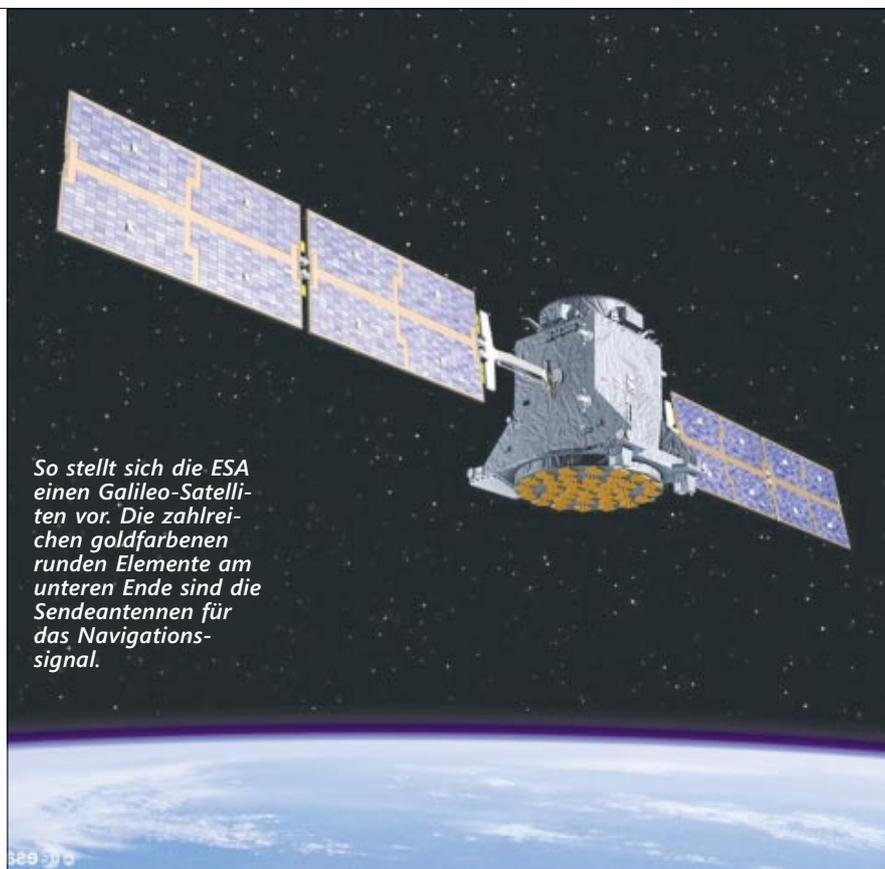
*So stellt sich die ESA einen Galileo-Satelliten vor. Die zahlreichen goldfarbenen runden Elemente am unteren Ende sind die Sendeantennen für das Navigationssignal.*
