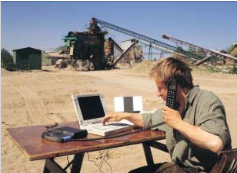
Bild 15. Inmarsat-GAN-Gerät TT-3080A. Links vom Laptop befindet sich das Modem und rechts die ausgerichtete Antenne zu einem Inmarsat-Satelliten. (Foto: Thrane & Thrane [16])
