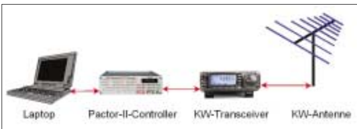
Bild 2. Pactor-Modem der Firma SCS und seine Anordnung in einer Sendeanlage zwischen Laptop und KW-Transceiver. (Bild: SCS)
